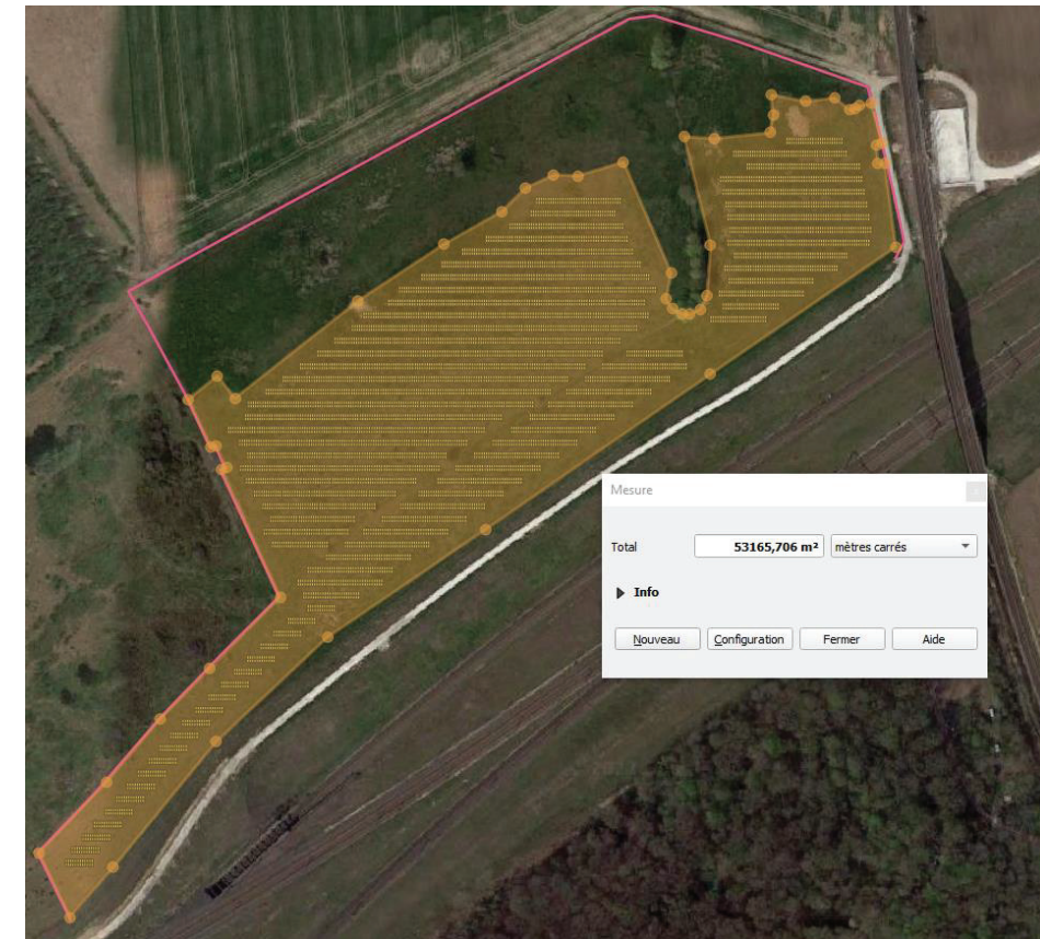
Figure 4 : Plan de masse de l'implantation du projet photovoltaïque (rose : clôture ; orange : surface concernée par les panneaux)
